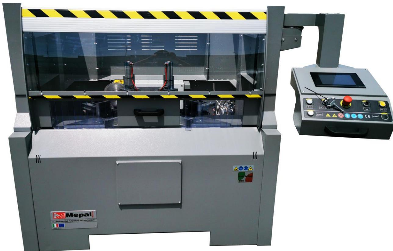
Il centro CNC di contornatura EDGE è un centro orizzontale compatto controllato in grado di fresare ed intestare profili in PVC.
